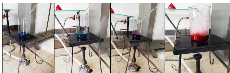
Figura 14. Titolazione con la soluzione del mosto, secondo la procedura del saggio di Fehling.
