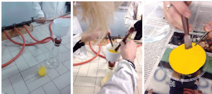
Figura 2- Preparazione del colore giallo PbI_2 da stendere su foglio.
