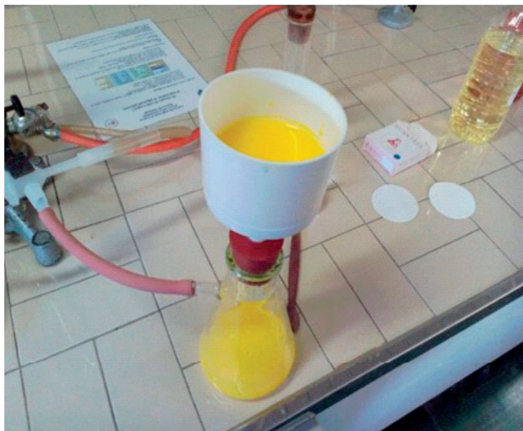
Figura 1 - Filtrazione del PbI_2 per la preparazione del pigmento giallo
