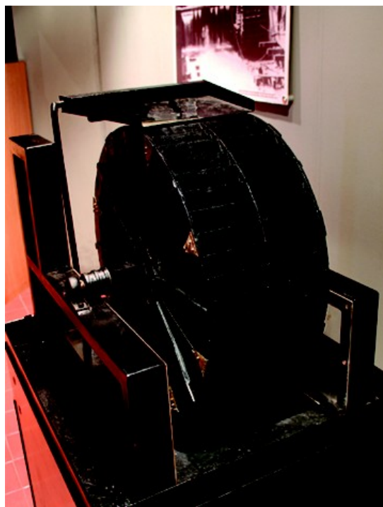
Fig. 5 e 6 Grande ruota a pale (mulino da grano -figura 5-) e ruota idraulica (mulino da seta -figura 6-): la spinta dell'acqua dall'alto mette in moto la ruota idraulica con maggior continuità e potenza rispetto a quella a pale, permettendone la riduzione delle misure e la collocazione all'interno delle abitazioni nelle cantine.
