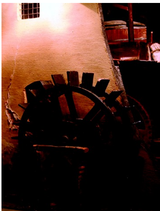
Fig. 5 e 6 Grande ruota a pale (mulino da grano -figura 5-) e ruota idraulica (mulino da seta -figura 6-): la spinta dell'acqua dall'alto mette in moto la ruota idraulica con maggior continuità e potenza rispetto a quella a pale, permettendone la riduzione delle misure e la collocazione all'interno delle abitazioni nelle cantine.
