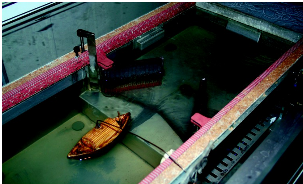
Fig. 3 Modello di funzionamento della Conca Vinciana utilizzata per rendere possibile la navigazione in quei corsi d'acqua che presentano significativi dislivelli come nel Canale Navile nel tratto fra Corticella e Malalbergo. Il sistema permette di regolare il livello di pescaggio con l'immissione o l'emissione di acqua attraverso appositi condotti, sistemati nel punto di dislivello.
