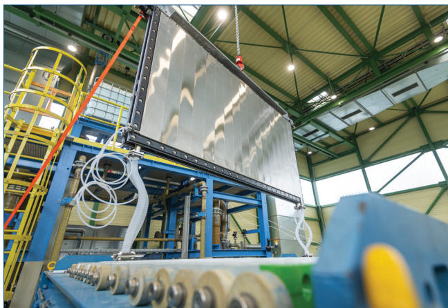
Fig. 3 - Produzione di celle di elettrolisi per acqua alcalina per thyssenkrupp Nucera presso lo stabilimento produttivo di De Nora Deutschland (Rodenbach, Germania)
